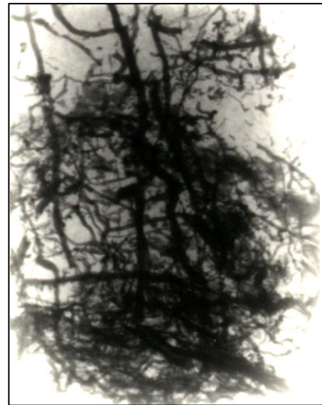
写真 9 表層土壌の間隙構造 [ 写真提供：京都大学 丸山利輔名誉教授 バリウムを浸透させたのち X線撮影 ]
