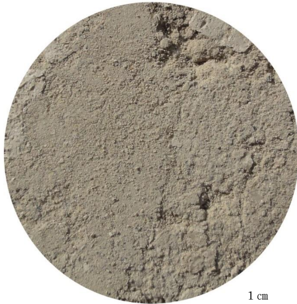
写真13 浅海成粘土層に見る不均一性 (千葉市東京湾岸、深度33.20mより採取した不攪乱試料)
