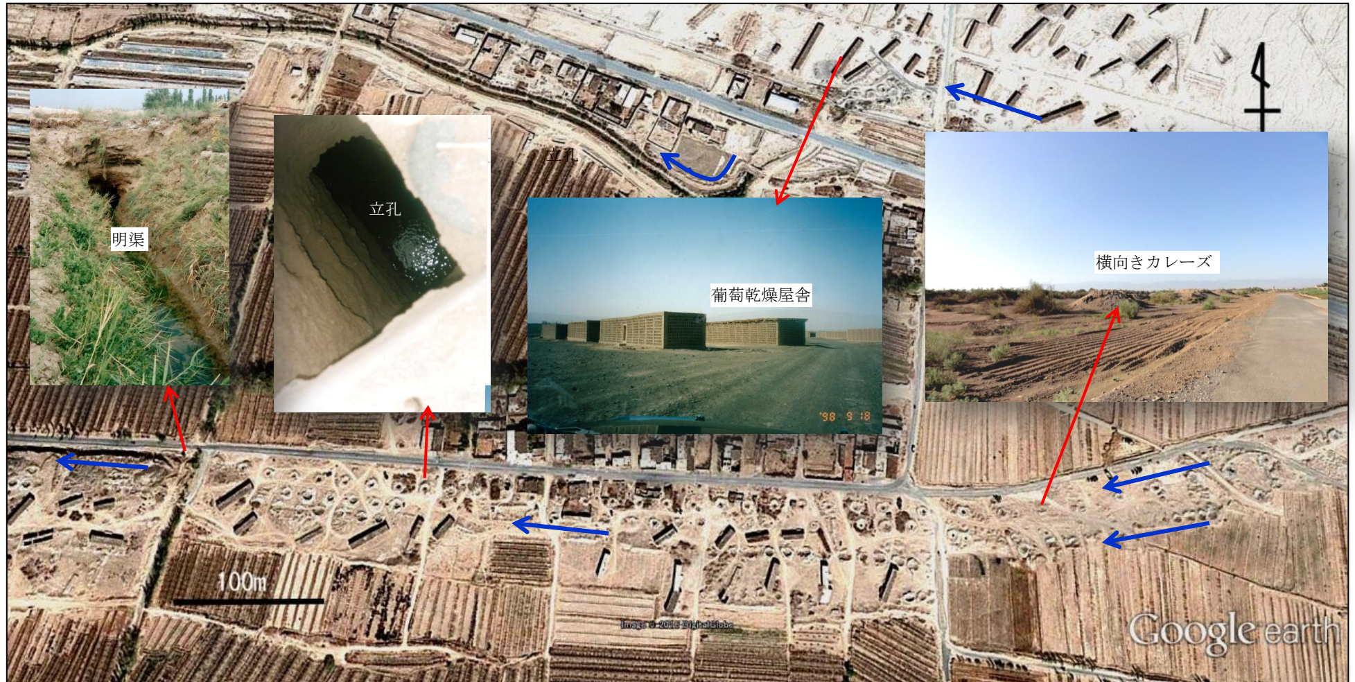
写真 27 火炎山北麓の“横向きカレーズ”の例 (この写真の南側に火炎山の山稜が東西に走る)
