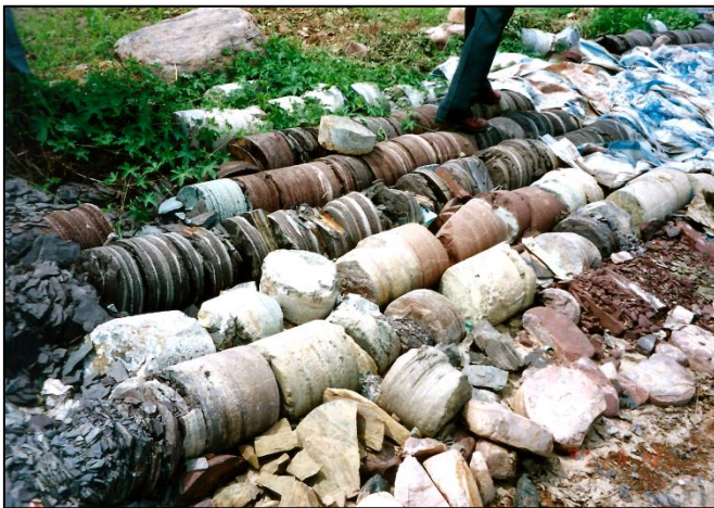
写真 35 炭層のボーリングコア (裂罅が発達し、多量の地下水が存在する)
