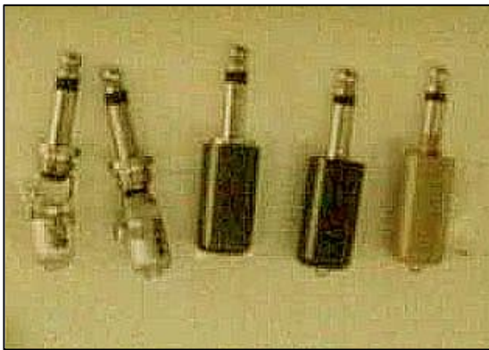
写真 19 R, C 素子 (左 2 つはコンデンサ、右 3 つは電気抵抗)
