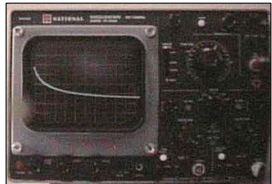
写真 22 オシロスコープ (画面は水位低下曲線)
