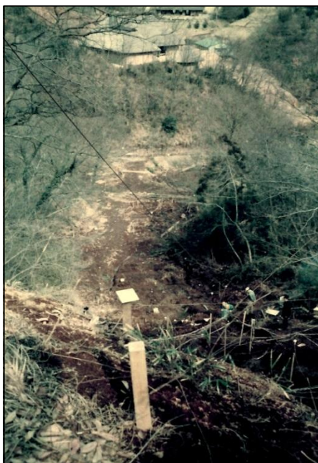
写真5 崩壊頂部より下流を俯瞰 崩土は横に広がっていて、かつ薄いことから流動性が高かったことが推察される
