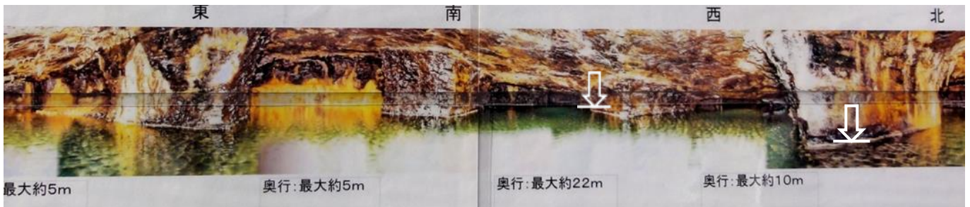
35 垂炭廃鉱内部の様子，矢印は地下水面 (出典：飛島・栗山特定建設共同体資料)
