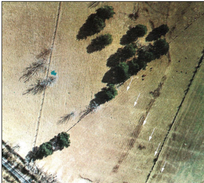
写真 43 植生ストレスと地下排水に起因する表層沈下
