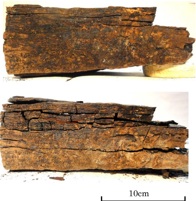
写真 34 乾燥に伴う亜炭層の劣化
