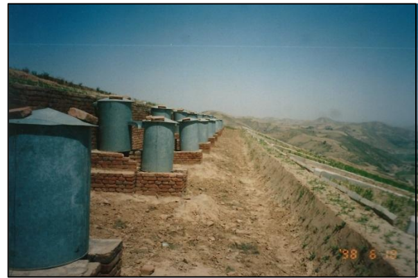
写真 54, 55 自然斜面を利用したライシメータ (陝西省安塞 水土保持総合試験場)
