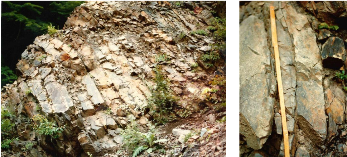
写真 81 チャートからなる岩盤クリープ (大井川支流東河内川、瀬戸川層群)
