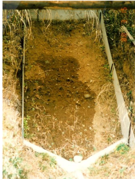
写真 60 50度斜面での滲出状況
