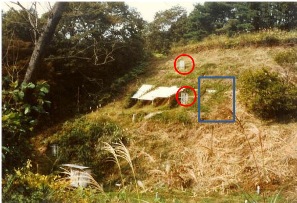
写真 58 切り取り斜面での地中水の動態観測
