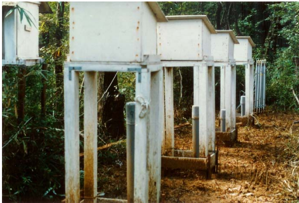
写真 35 稜線部に配置した深度別観測井 (図 22 の A 地点)
