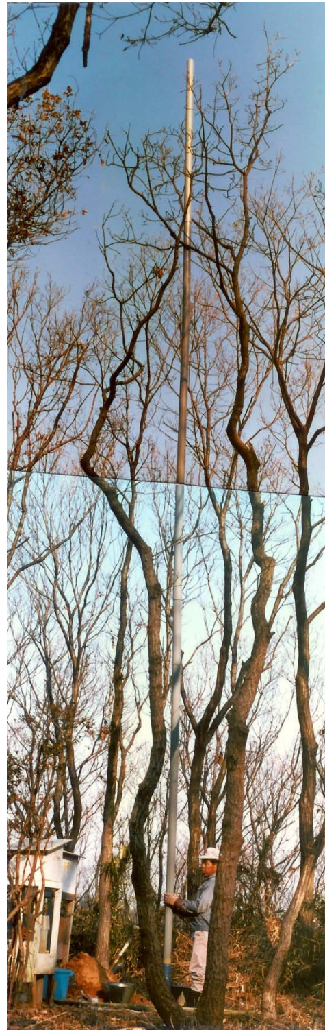
写真 36 ハンドオーガによる観測井 図 22 の B 地点、長さ 10m に及ぶ手掘りに よる山頂部でのケーシングは他に例を見ない のでは？
