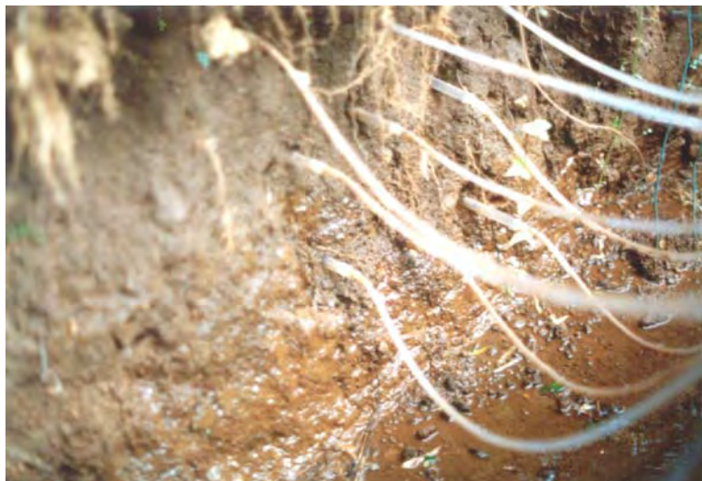
写真 28 トレンチ面とテンシオメータの設置状況
