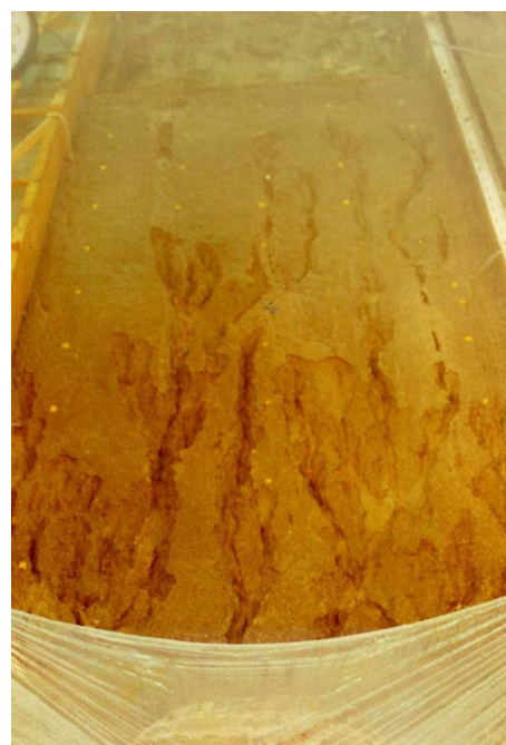
写真 15 地中水を集めながらガリが分岐し、 上流に向かって伸長する
