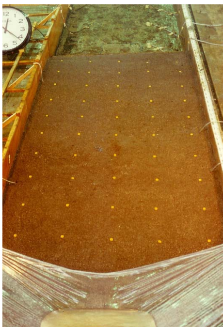
写真 12 軽石層の上に火山灰を敷き詰める
