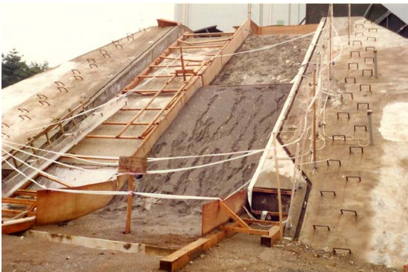
写真 11 有珠火山噴出物を用いた降雨実験
