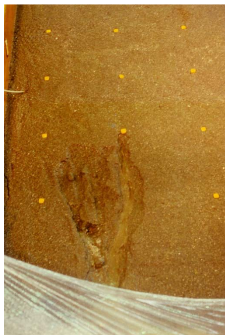
写真 13 ガリ浸食は斜面末端部から始まる
