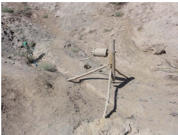
写真 17 浚渫土砂の巻き上げ器
