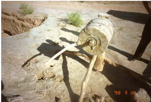
写真 13 土砂巻上げ装置
