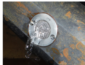
プローブ側面、排水口からの水の排水状況(250mL/min)
